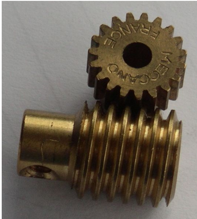
Rys. 4.19. Prosta realizacja miniaturowej przekładni ślimakowej: ślimacznicą ma postać zwykłego koła zębatego o zębach prostych, ślimak ma postać śruby
