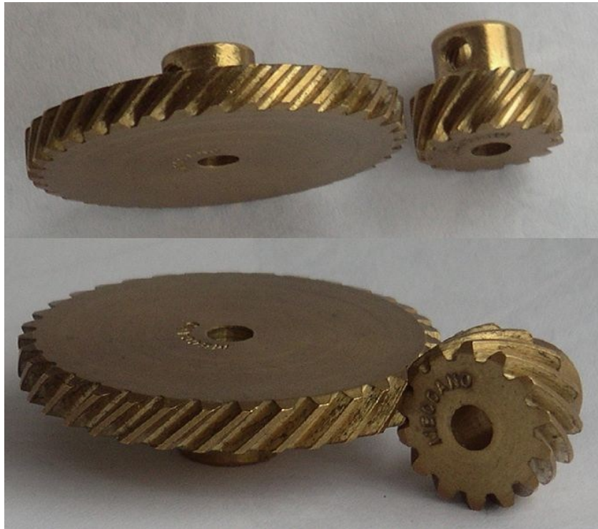
Rys. 4.17. Przekładnie drobnomodulowe, frezowane w mosiądzu: walcowa o zębach skośnych (u góry) i kątowna (u dołu)
