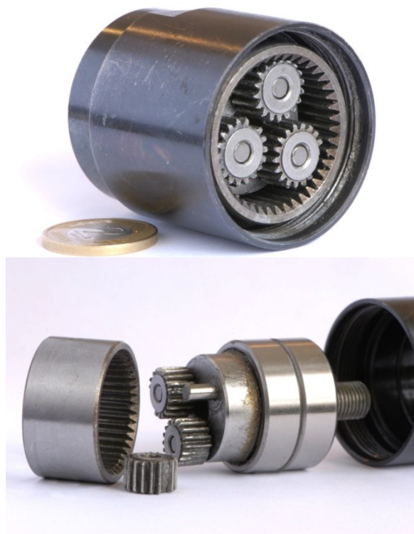
Rys. 4.23. Przekładnia obiegowa (planetarna) ręcznej wiertarki (widać ponadto wylamane zęby)
